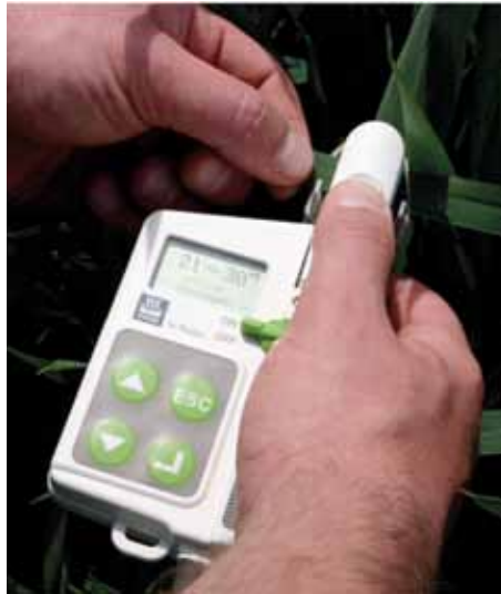
4. kép: Yara N-teszter működés közben.
