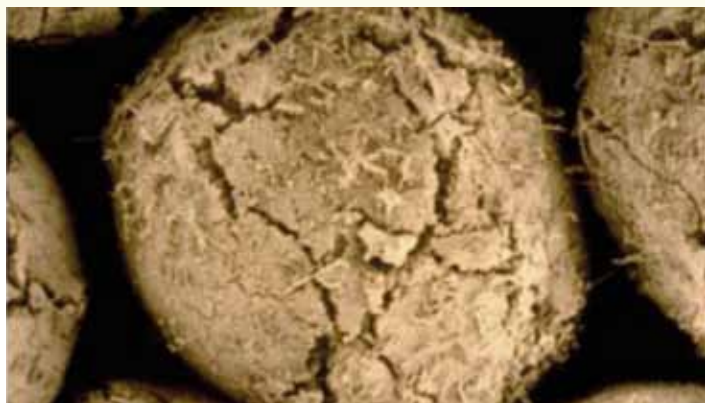
Vízfelvétel következtében szétesett műtrágya szemcse
