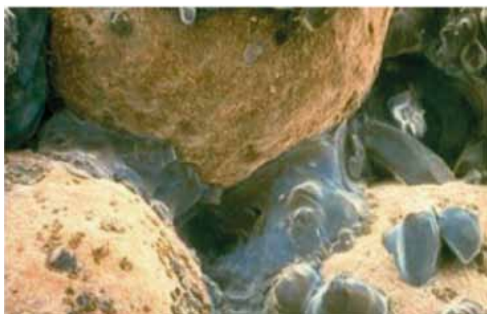
A szemcsék között kialakult kristály hidak tapadást eredményeznek
