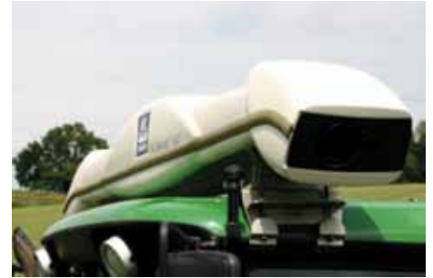
7. kép: A Yara N-szenzor érzékelőfeje közelről. A kisebbik fejen történik a fény kibocsátása, a nagyobbik pedig a visszaverődő fényt érzékeli.
