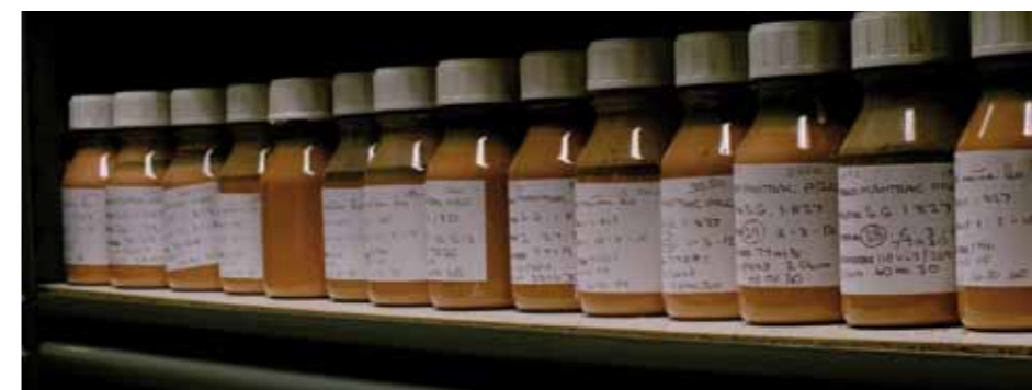
A folyamatos minőség-ellenőrzés érdekében, műszakonként minden legyártott tételből mintát vesznek, illetve ellenőrzik, hogy megfelel-e a specifikációknak. A vizsgálat után a mintákat archiválják, vagyis elteszik 2 évre.
